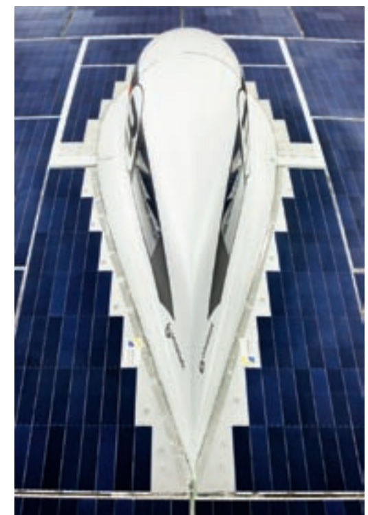
De breedte van de heupen van de coureur bepaalt de maat van de gestroomlijnde cockpit.
