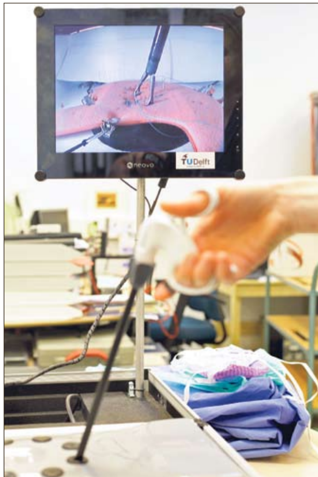
In het medisch instrumentenlab bij 3mE pakt Dorette Spaans het handvat van een endotrainer vast. Daarmee oefent ze hoe het is om patiënten niet meer helemaal open te snijden, maar haar operatie-instrumenten door kleine sneetjes in lichaam te brengen.
