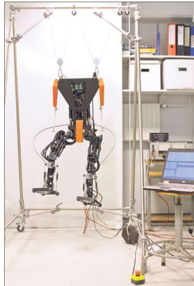
TULip is het grootste exemplaar dat binnenkort gaat meedoen aan een robotvoetbaltoernooi. Er zijn veel biomechanische studenten die hun best doen om TULip zo energie-efficiënt mogelijk te laten lopen.
